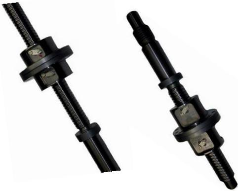
Конструкторско-технологические макеты передач ШВП «грубого» и «точного» редукторов линейного привода ГСАКР
