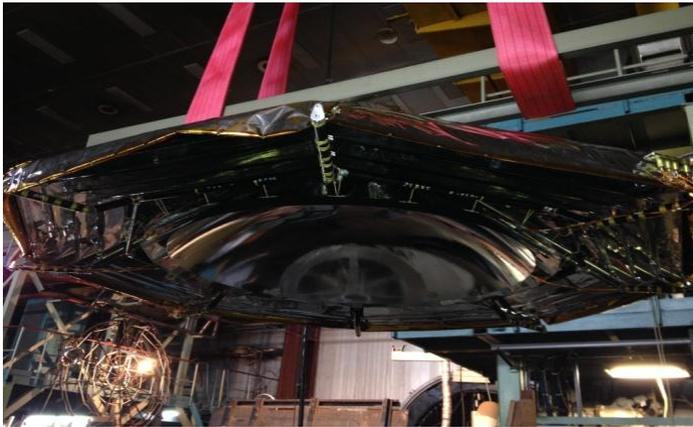
Проведены испытания в криогенных условиях, по результатам которых верифицирована теплофизическая модель
