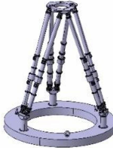
Рабочее место для изготовления и проведения автономных испытаний системы адаптации переключающего зеркала
