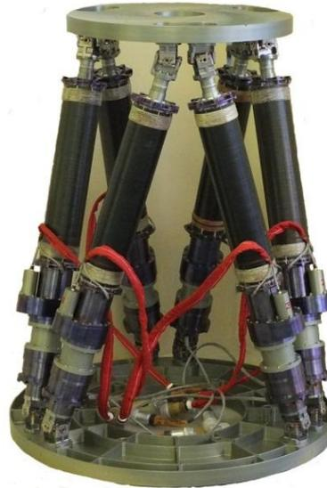
Макет гексапода для отработки алгоритмов управления
