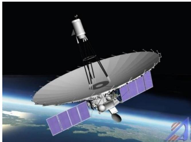
**Космический радиотелескоп** с приёмной параболической антенной диаметром 10 метров выведен на высокоапогейную орбиту спутника Земли высотой до 350 тыс. км в составе космического аппарата «Спектр-Р».
