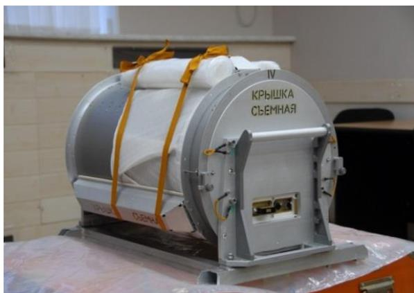
**Рис.1.** Транспортно-пусковое устройство (ТПУ)
