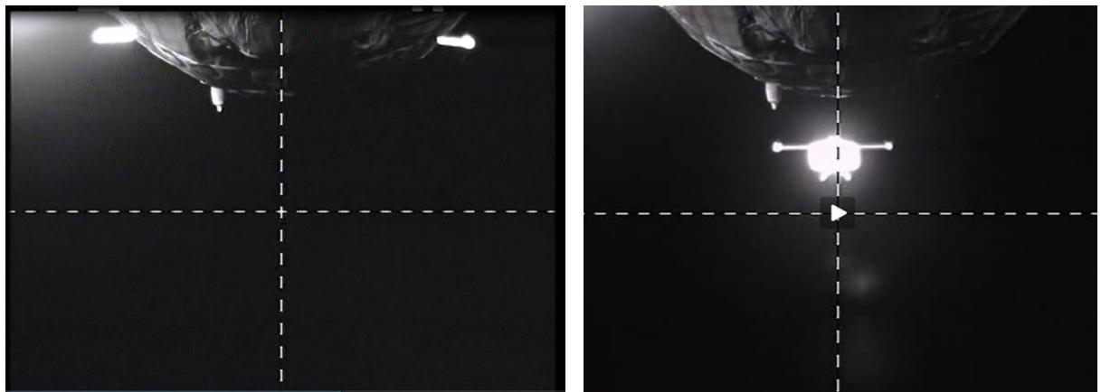
**Figure 3.** Separation of «Chibis-M» from TCS «Progress»
