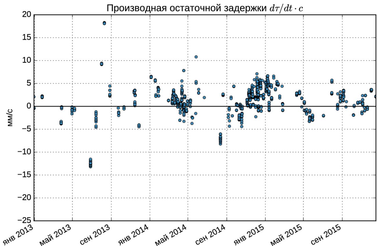
Рис. 1. Производная остаточной задержки в скоростном выражении \frac{d\tau}{dt} c , характеризующая точность определения скорости КА в направлении на наблюдаемый источник. Техническое задание допускает отклонения до 2 см/с.
